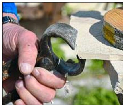
Jeder Schlag sitzt: Erich Regler bringt mit dem Hackhammer das Rohmaterial in Form. Er bearbeitet dabei den Stein immer genau an der aufgezeichneten Linie entlang. Mit eisernen Zangen wird das Material gezwickt (unten, Mitte). Auch andere alte Gerätschaften hat der 79-Jährige gesammelt: Den Handschuh hat seine Mutter für seinen Vater gestrickt, mit dem Brenneisen (unten rechts) machten sich die Frauen früher Locken.
