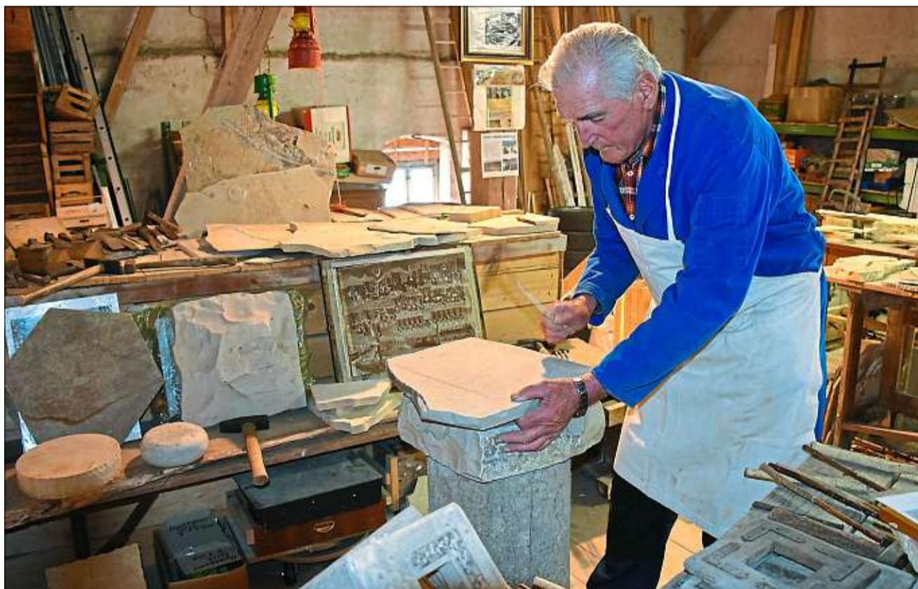
Jeder Schlag sitzt: Erich Regler bringt mit dem Hackhammer das Rohmaterial in Form. Er bearbeitet dabei den Stein immer genau an der aufgezeichneten Linie entlang. Mit eisernen Zangen wird das Material gezwickt (unten, Mitte). Auch andere alte Gerätschaften hat der 79-Jährige gesammelt: Den Handschuh hat seine Mutter für seinen Vater gestrickt, mit dem Brenneisen (unten rechts) machten sich die Frauen früher Locken.
