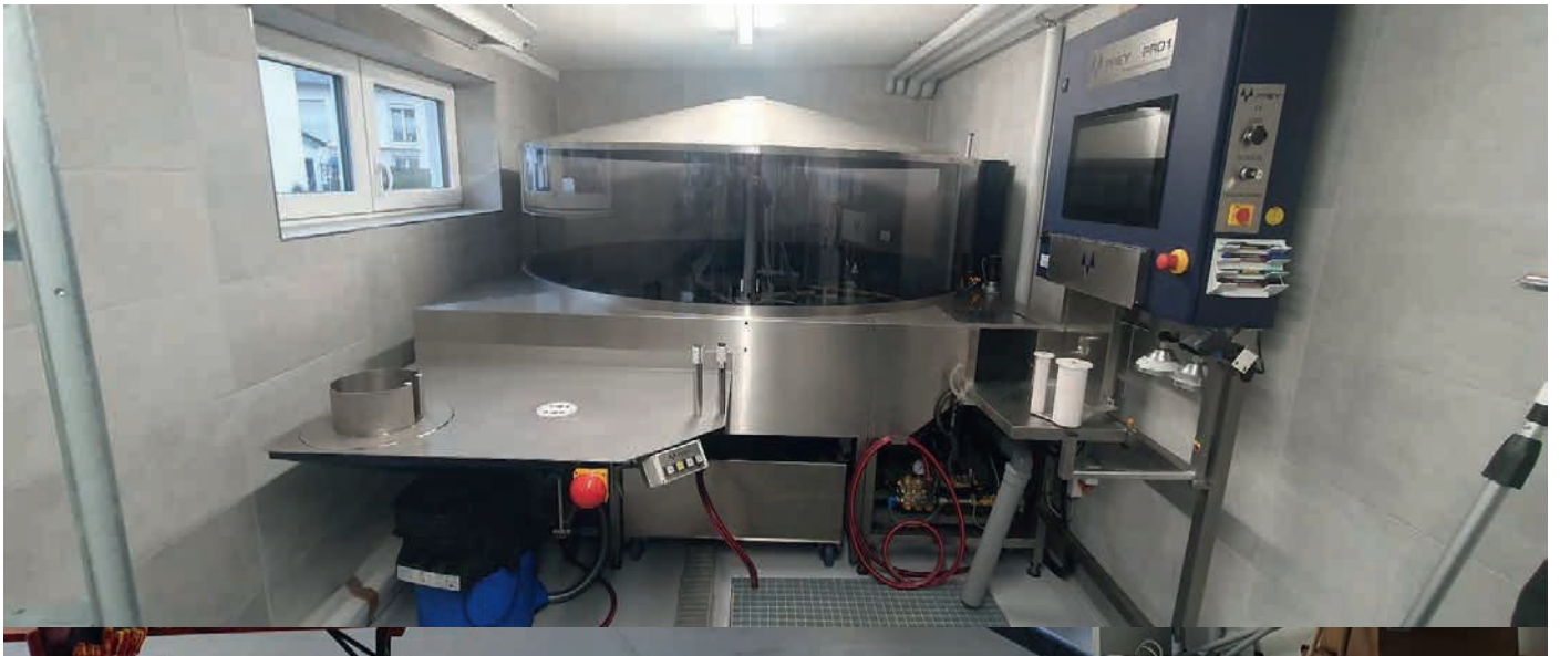
Schlauchwaschanlage - hier werden die Schläuche von allen Wehren gereinigt, getrocknet und geprüft.
